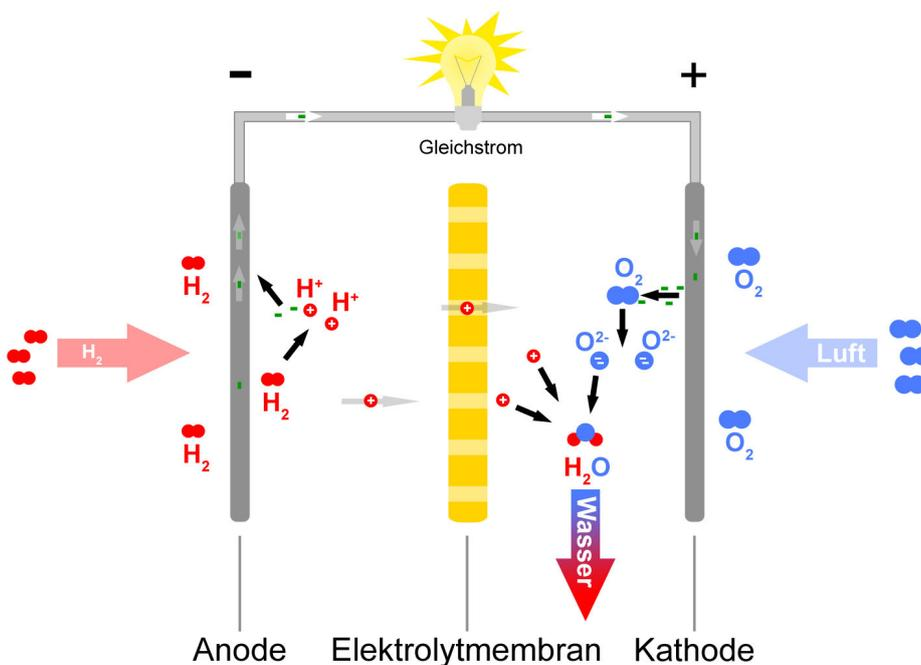
Abbildung 13: Schematische Darstellung des Funktionsprinzips einer Brennstoffzelle (Christoph Lingg, wikipedia.de)
