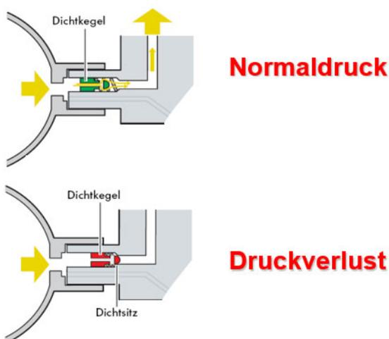
Abbildung 25: Funktionsprinzip des Durchflussmengenbegrenzers (Volkswagen AG)
