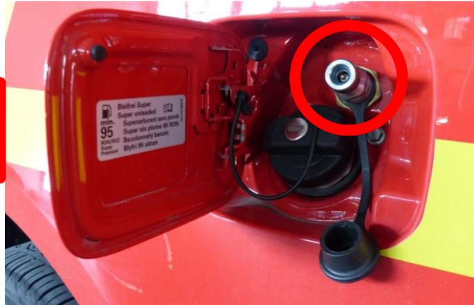
Abbildung 21: Zusätzlicher Tankstutzen für Betankung von Erdgas (SFS Würzburg Winterschulung „Alternative Antriebe“)
