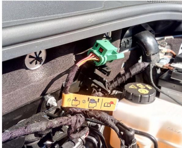
Abbildung 9: HV Trennstelle für Einsatzkräfte (Wolfgang Niederauer, ÖBFV)
