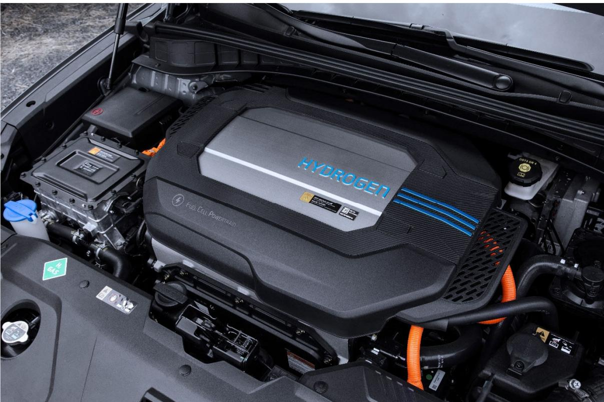
Abbildung 16: Motorraum eines Fahrzeuges mit Brennstoffzelle (Hyundai)
