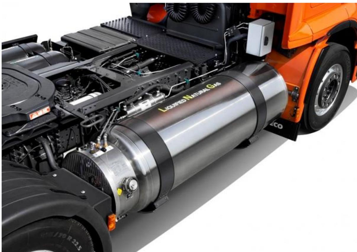
Abbildung 27: LNG - Tank (isoliert) (Iveco)
