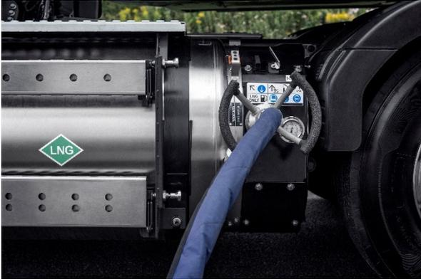
Abbildung 30: LNG Betankung (Volvo)
