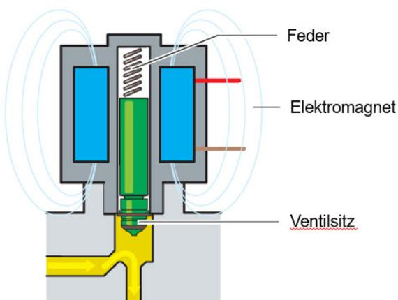
Abbildung 23: Funktionsprinzip eines elektromagnetischen Absperrventils (Volkswagen AG)
