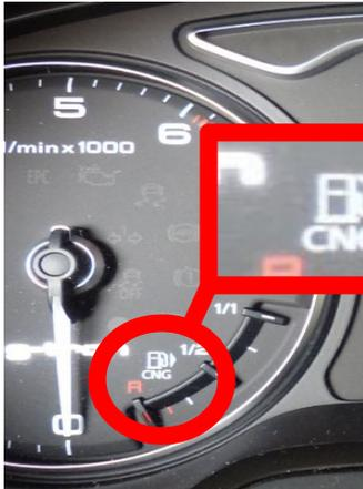
Abbildung 20: Anzeige CNG in der Instrumententafel (Audi AG)
