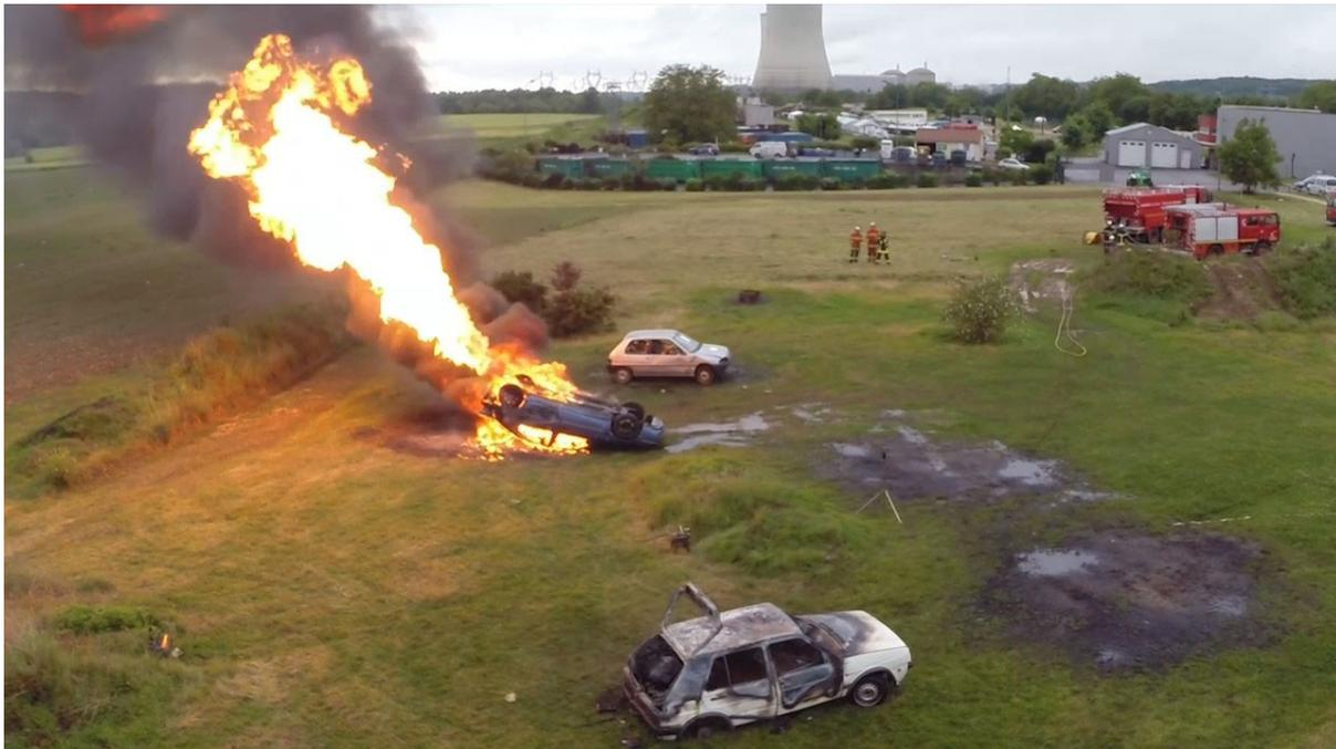
Abbildung 48: Austritt von Flüssiggas in Flüssigphase (Sapeurs-pompiers de la Vienne)
