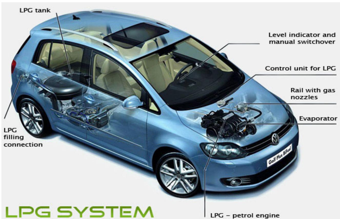
Abbildung 31: Antriebssystem LPG-Fahrzeug (Volkswagen AG)
