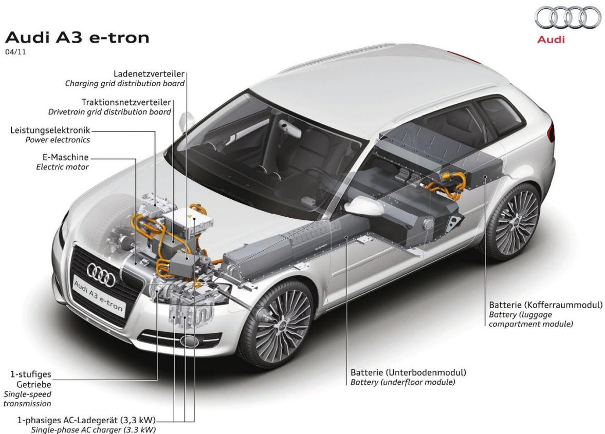
Abbildung 5: Komponenten eines Elektrofahrzeuges (Audi AG)
