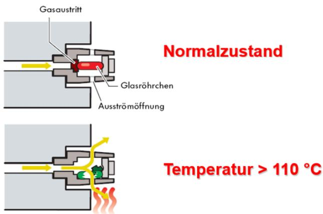
Abbildung 24: Funktionsprinzip der Thermosicherung (Volkswagen AG)
