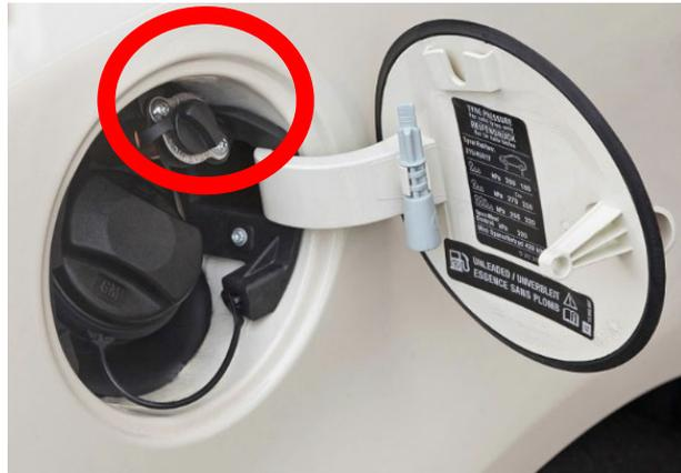
Abbildung 33: Zusätzlicher Tankstutzen für die Betankung von Erdgas (Volkswagen AG)
