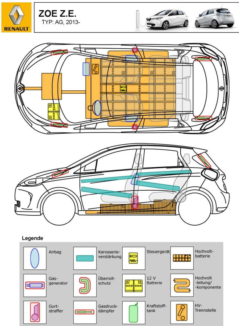
Abbildung 46: Beispiel eines Rettungsdatenblatts (Renault)
