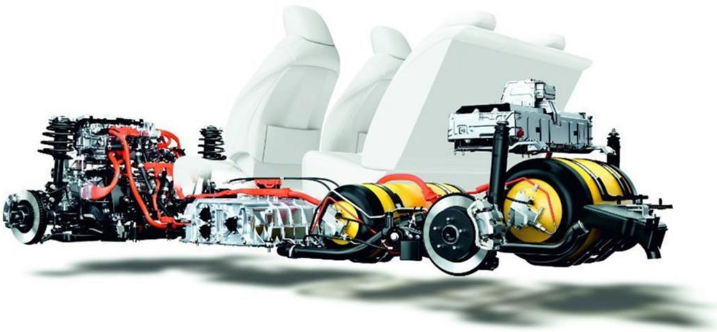
Abbildung 12: Darstellung eines Wasserstoff / Brennstoffzelle Antriebs (Toyota)
