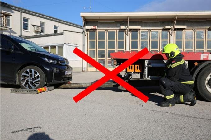
Abbildung 52: Kein Schleppen von Hybrid- und Elektrofahrzeugen (Wolfgang Niederauer, ÖBFV)
