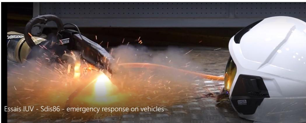
Abbildung 11: Lichtbogen beim Trennen einer 48 Volt Leitung (Sapeurs-pompiers de la Vienne, ÖBFV Film Gefahrenlehre)
