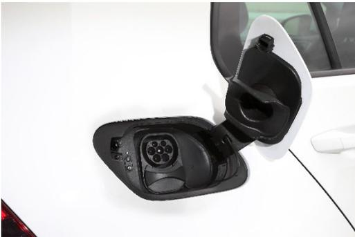
Abbildung 6: Lademöglichkeit hinter Tankdeckel (Volkswagen AG)
