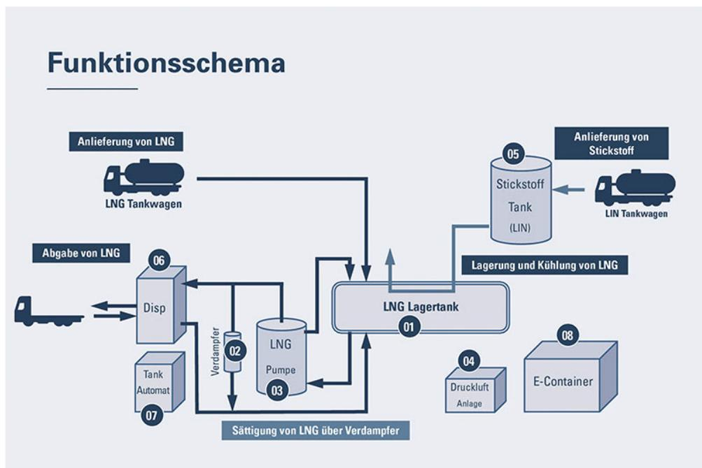
Abbildung 42: LNG Funktionsschema (RAG Austria AG)
