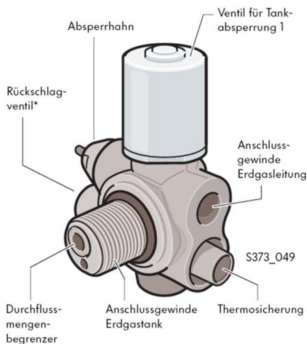
Abbildung 22: Sicherheitsventil für Erdgasfahrzeuge (Volkswagen AG)
