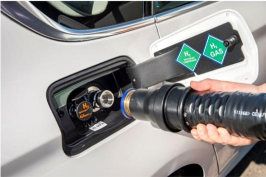
Abbildung 15: Betankungssystem Wasserstoff (Audi AG)
