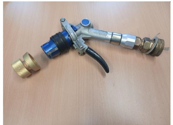
Abbildung 44: LPG Zapfhahn mit
